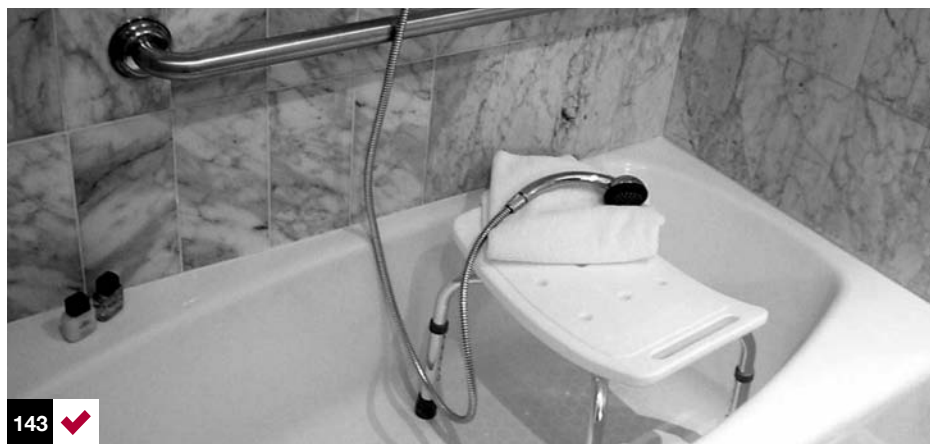
Foto 143: asiento para ser colocado dentro de la tina. Adecuado para personas que no pueden permanecer mucho tiempo de pie. Su uso es de tipo doméstico, no se recomienda para hoteles ya que no es de uso universal.
