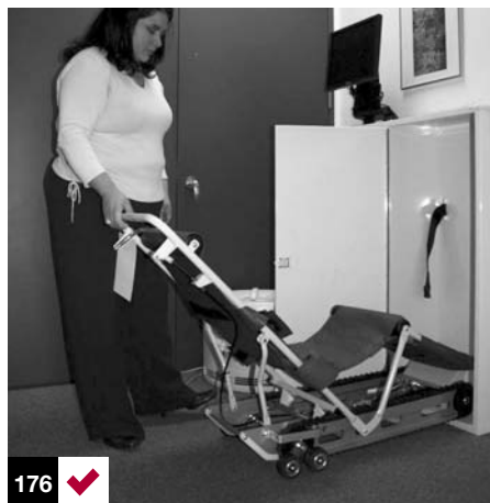
Foto 176: la forma más segura de evacuar personas con movilidad reducida por escaleras es con una silla de evacuación. Oficina ILRU. Houston, EE.UU.
